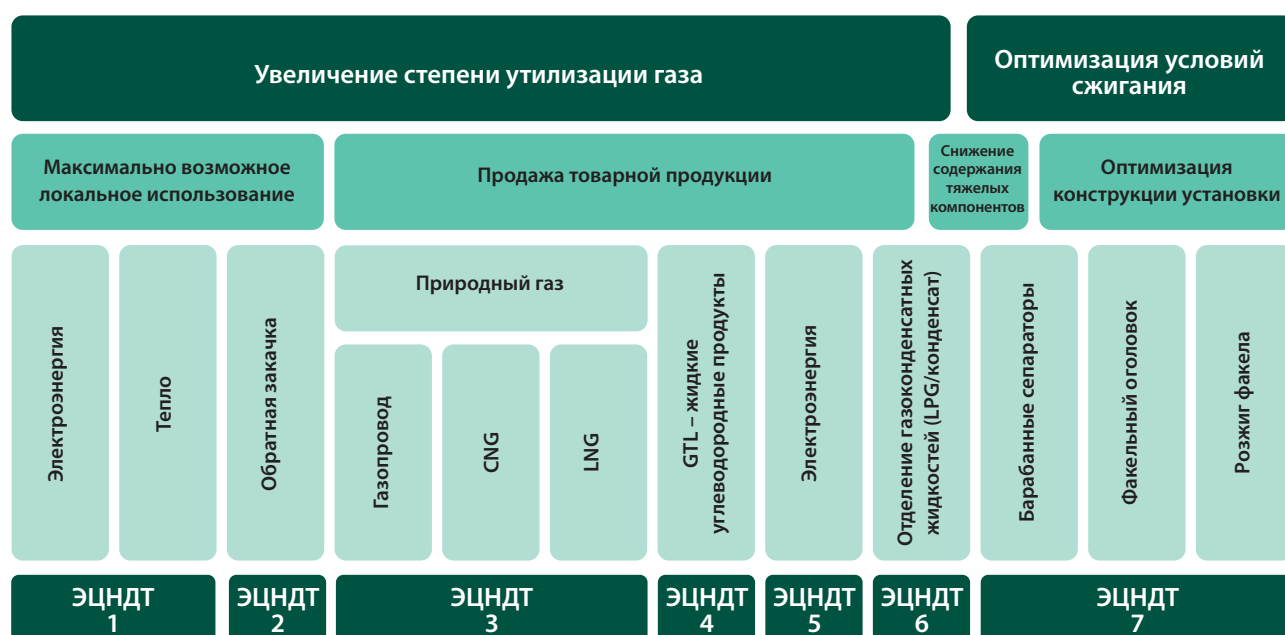
Рисунок 7. Обзор Экономически Целесообразных Наилучших Доступных Технологий (ЭЦНДТ) снижения выбросов ЧУ от факельного сжигания.
